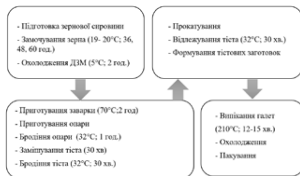
Рис. 2. Функціонально-параметрична схема виробництва галет із диспергованою кукурудзою
